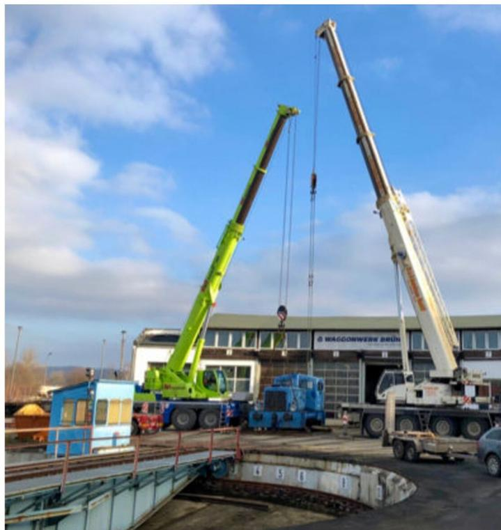
Mit zwei Automobilkränen wird am 08.12.2020 die Lok 5 vom Gelände des Waggonwerkes Brühl in Vacha zum Transport in das Dampflokwerk Meiningen auf einen Tieflader gehoben. Bild: Steffen Dietsch
